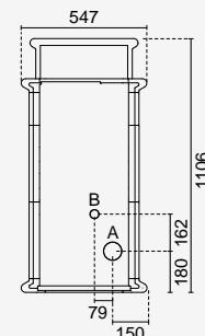
A = Ø 80 mm Wyłot spalin / Scarico fumi
